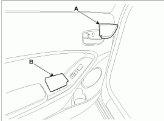
3. 拧下固定螺钉，拆卸后车门装饰板 (A)。
