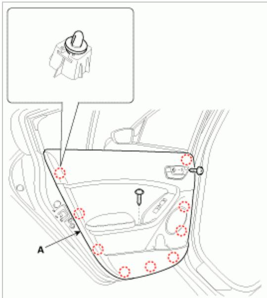
4. 拆卸后车门内侧手柄保持架 (A)。
